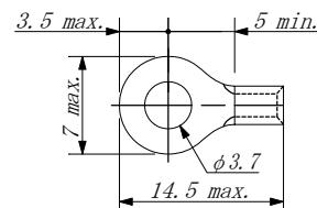
※1つの端子ネジに対して接続する圧着端子は2つを限度としてください。また、2つ接続する場合の圧着端子厚は1つの圧着端子に付き 0.8mm 以下としてください。
