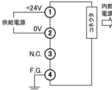
※接地は単独接地、もしくは電流が流れ込まない接地を使用して下さい。
