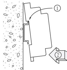
ソケット基板についているレールホルダを下にして、その反対方向にあるツメをレールに引っ掛けてからソケットを図のように嵌め込み、レールホルダをかけて固定します。
