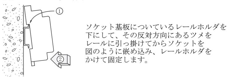
ソケット基板についているレールホルダを下にして、その反対方向にあるツメをレールに引っ掛けてからソケットを図のように嵌め込み、レールホルダをかけて固定します。
