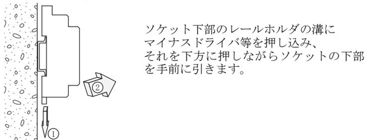
ソケット下部のレールホルダの溝にマイナスドライバー等押し込み、それを下方に押しながらソケットの下部を手前に引きます。
