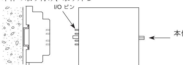
①本体の上下方向を確認して、各入出力ピンと対応するソケットの位置とを合わせ、本体をまっすぐ押し込んでください。
