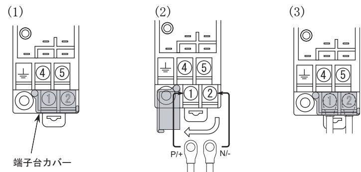
注)安全の為、活線状態での作業は避けてください。締め付け作業後は全ての端子ネジが十分に締まっていることを都度確認してください。
