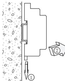
ソケット下部のレールホルダの溝にマイナスドライバー等を押し込み、それを下方に押しながらソケットの下部を手前に引きます。
