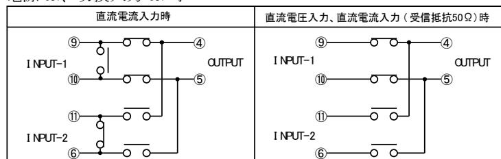
電源 ON、切換入力 ON から OFF、又は OFF から ON にした時の内部接点移行状態 ※切換移行時間は応答速度に含まれます。
