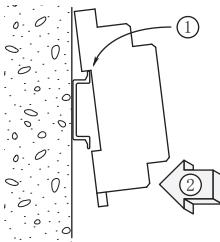
ソケット基板についているレールホルダを下にして、その反対方向にあるツメをレールに引っ掛けながらソケットを図のように嵌め込み、レールホルダをかけて固定します。
