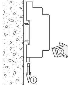
ソケット下部のレールホルダの溝にマイナスドライバ等押し込み、それを下方に押しながらソケットの下部を手前に引きます。
