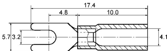
丸形圧着端子外形図(単位:mm)
