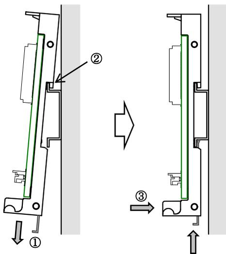
DIN レール固定金具「①」を下側にスライドさせた状態で、ベースユニット背面にあるフック「②」を DIN レールに引っ掛けます。
