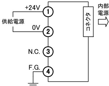
※接地は単独接地、もしくは電流が流れ込まない接地を使用して下さい。
