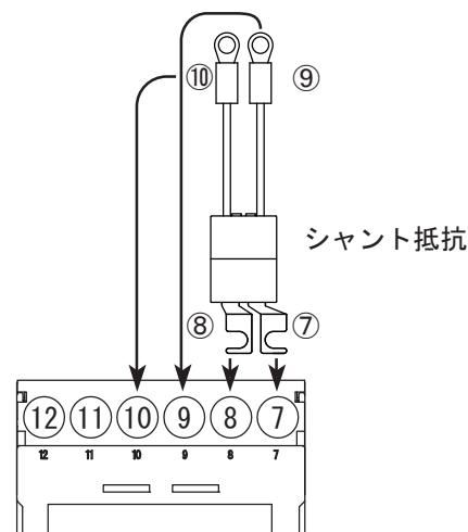
MS3120 は、必ずシャント抵抗器を取り付けてご使用ください。シャント抵抗器を取り外して使用した場合、CT の 2 次側が開放状態となり CT を焼損するおそれがあります。
