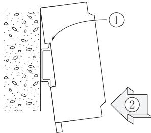
製品についているレールホルダを下にして、その反対方向にあるツメをレールに引っ掛けたから製品を図のよう嵌め込み、レールホルダをかけて固定します。
