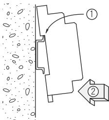
ソケット基板についているレールホルダを下にして、その反対方向にあるツメをレールに引っ掛けたからソケットを図のように嵌め込み、レールホルダをかけて固定します。
