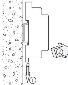
ソケット下部のレールホルダの溝にマイナスドライバー等を押込み、それを下方に押しながらソケットの下部を手前に引きます。
