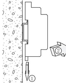
ソケット下部のレールホルダの溝にマイナスドライバ等を押し込み、それを下方に押ししながらソケットの下部を手前に引きます。
