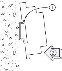
ソケット基板についているレールホルダを下にして、その反対方向にあるツメをレールに引っ掛けながらソケットを図のように嵌め込み、レールホルダをかけて固定します。
