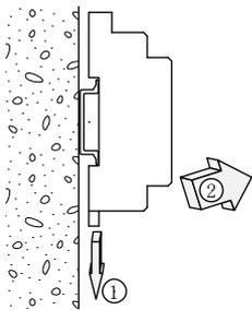
ソケット下部のレールホルダの溝にマイナスドライバ等を押込み、それを下方に押しながらソケットの下部を手前に引きます。
