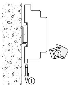
ソケット下部のレールホルダの溝にマイナスドライバー等を押し込み、それを下方に押しながらソケットの下部を手前に引きます。
