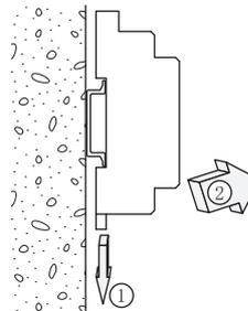
ソケット下部のレールホルダの溝にマイナスドライバー等押し込み、それを下方に押しながらソケットの下部を手前に引きます。
