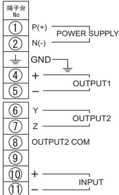
※2 線式供給電源付の配線はセンサの種類により接続が異なります。
