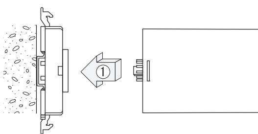
本体の上下方向を確認して、各入出力ピンと対応する端子台の位置とを合わせ、本体をまっすぐ挿し込んでください。
