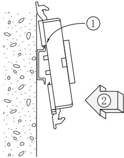
ソケット基盤についているレールホルダ（黄色の部分）を下にして、その反対方向にあるツメをレールに引っ掛けながらソケットを図のように嵌め込み、レールホルダをかけて固定します。
