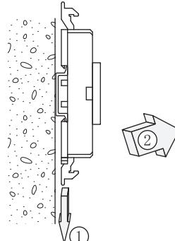
ソケット下部のレールホルダの溝にマイナス・ドライバ等を挿しこみ、それを下方に押しながらソケットの下部を手前に引きます。
