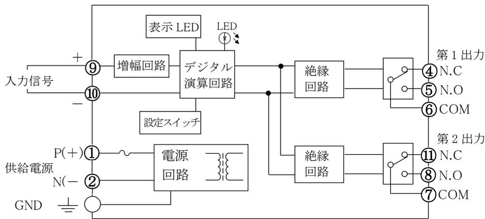
\* 出力にモータ等の誘導性負荷を接続する場合は、リレー接点保護回路を接続して下さい。
