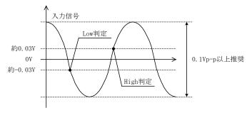
・D コード仕様: DC 電圧パルス入力/スレッシュ電圧:約2V
