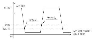
・M コード仕様:オープンコレクタ入力/スレッシュ電圧:約5V アズビル社製 電磁流量計 MGG10C 等、残留電圧が1.5V以上の入力信号に対応。
